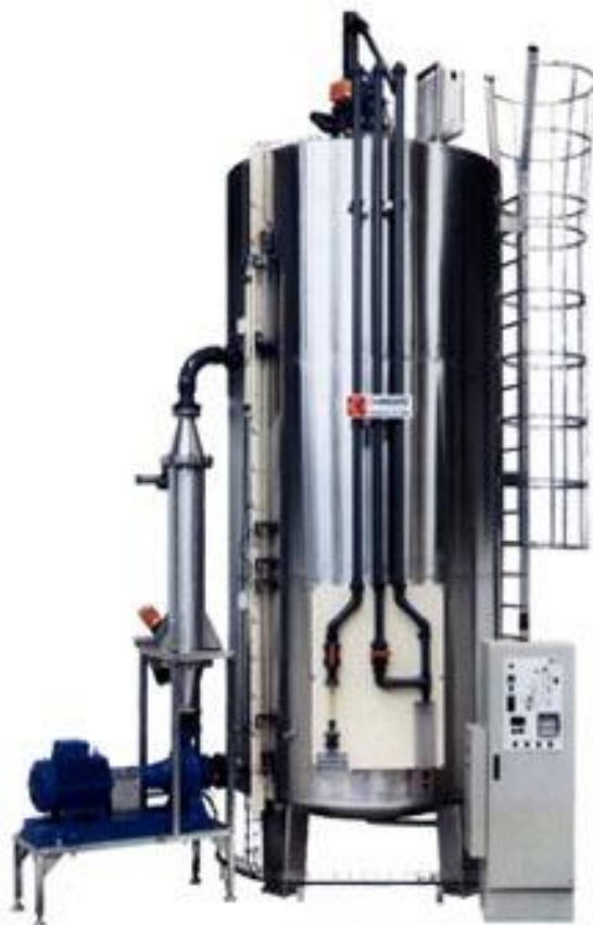
Photographie d'un bioréacteur utilisé pour cultiver le micro-organisme qui produit EPIDERMIST 4.0
